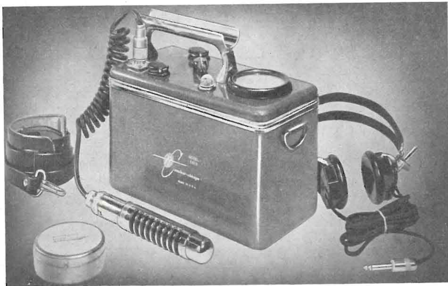
Una Compagnia americana annuncia di aver posto sul mercato un contatore di Geiger portatile per prospezione di minerali radioattivi. Si tratta del modello 2612 L della Nuclear Instrument and Chemical Co. di New York. Poiché lo strumento è previsto in particolare modo per la prospezione di minerali di uranio, viene fornita una scatolaletta contenente sabbie uranifere (uranio 0,1 %) per misure di confronto.
